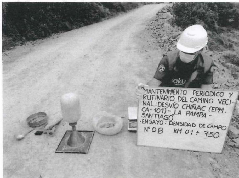
**FIGURA Nº 8.** Ensayo de Densidad de Suelo en Campo. Progresiva 01 + 750 (Método del cono de arena).
