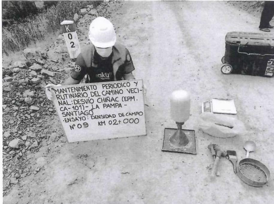
**FIGURA Nº 9.** Ensayo de Densidad de Suelo en Campo. Progresiva 02 + 000 (Método del cono de arena).
