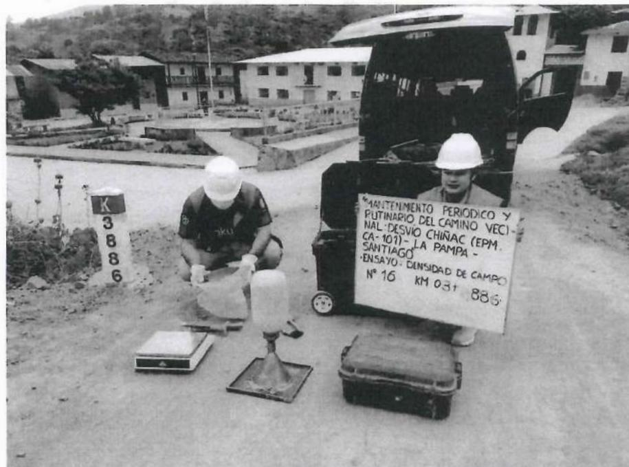
**FIGURA Nº 16.** Ensayo de Densidad de Suelo en Campo. Progresiva 03 + 886 (Método del cono de arena).
